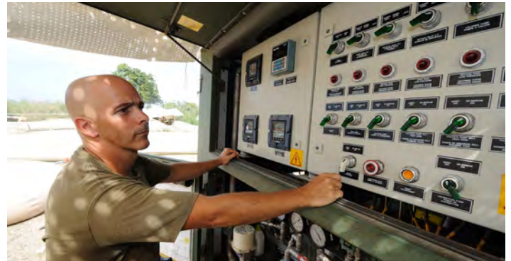
Sgt Luc Tellier, then of the Unité régionale de soutien aux cadets (URSC) Québec, operates a ROWPU in Léogane, Haiti, as part of Op Hestia. Photo: Sgt Bruno Turcotte
